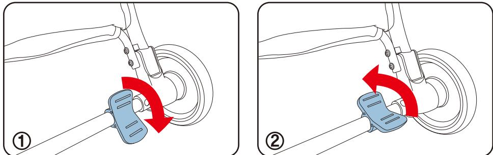
1. 브레이크 레버를 ①번의 그림 방향으로 누르면 브레이크가 잠기게 되고, 브레이크 레버를 ②번의 그림 방향으로 누르면 브레이크가 해제됩니다.
