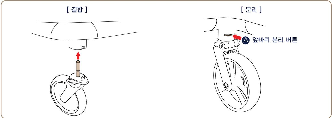
(a) 위 그림과 같이 앞바퀴를 앞바퀴 발목에 그림처럼 결합합니다. 반대쪽도 동일하게 결합합니다. 바퀴가 앞바퀴 발목에 “찰칵” 소리가 날 때까지 끼워 넣어 주시기 바랍니다. 만약 조립 시 소리가 나지 않는 경우 손으로 당겨 빠지지 않는지 확인 후 사용하기 바랍니다. 분리하실 때에는 **A** 앞바퀴 분리 버튼을 눌러서 분리해 주시기 바랍니다.
