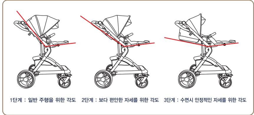
1. ①번의 그림처럼 등판의 시트 조절 레버를 화살표 방향으로 올려 원하는 각도로 조절합니다. 시트의 각도는 대면과 배면 상태 모두 3단계로, 최대 170도까지 조절할 수 있습니다.
