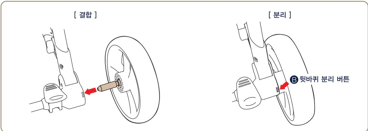
(a) 위 그림과 같이 뒷바퀴를 뒷바퀴 발목에 그림처럼 결합합니다. 반대쪽도 동일하게 결합합니다. 바퀴가 뒷바퀴 발목에 “찰칵” 소리가 날 때까지 끼워 넣어 주시기 바랍니다. 만약 조립 시 소리가 나지 않는 경우 손으로 당겨 빠지지 않는지 확인 후 사용하기 바랍니다. 분리하실 때에는 **B** 뒷바퀴 분리 버튼을 눌러서 분리해 주시기 바랍니다.
